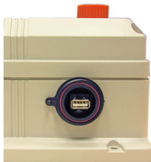
Insérer la clé dans le connecteur USB (côté droit de l'instrument) Après l'usage refermer la clé avec son capuchon
